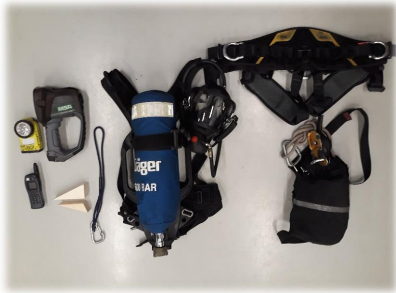
Kuva 3. Pelastusryhmän jäsenen henkilökohtaista perusvarustusta savusukellustilanteessa (Pelastusopisto).
