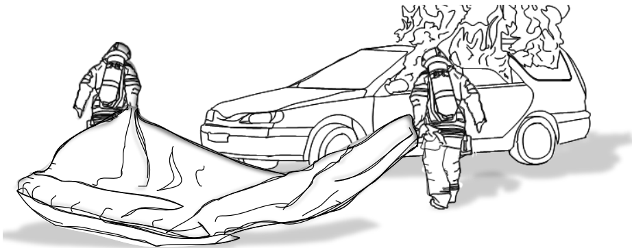
Kuva 44. Autopalon sammutus autonsammutuspeitteellä (Kuikka).
