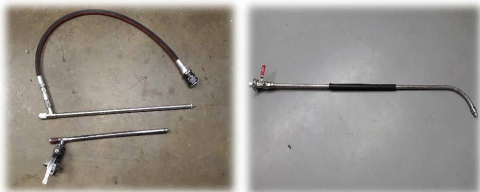
Kuva 13. Vasemmalla pistojauheputki ja pistosuihkuputki sekä oikealla erikoissuihkuputki pitkällä varrella (Pelastusopisto).
