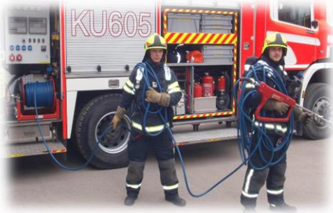
Kuva 21. Sammutinleikkuri, Cobra raivausautossa (Latvala).
