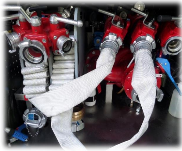
Kuva 8. Kiinteä autopumppu, jossa varmennettu pääjohto on valmiiksi liitetty pumppuun sekä vuorjakoliittimeen (Pelastusopisto).
