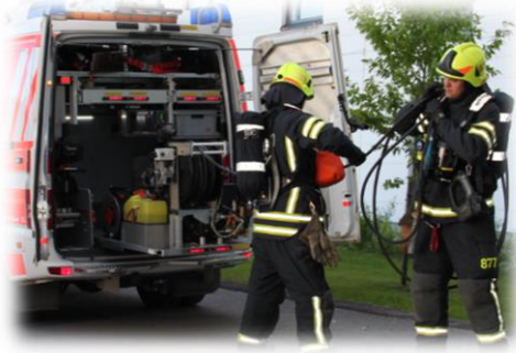
Kuva 20. UHPS kärkiyksikössä (Latvala).
