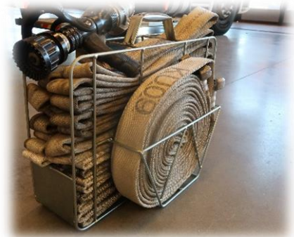
Kuva 10. Hyökkäyskehikko, jossa työjohtoa on kehikolla sekä kieppi työvarana (Latvala).
