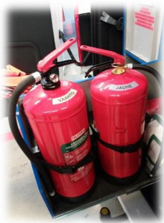
Kuva 14. Alkusammuttimia pelastusajoneuvossa. Sammuttimet on hyvä merkitä pelastuslaitoskäytössä väritarroilla: jauhe harmaa tarra, vahto beige tarra. (Latvala.)
